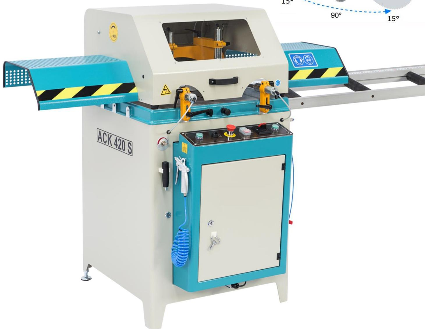
Permettant des **coupes droites et biaises jusqu'à +/- 75° à droite et à gauche** de profilés ALU.
